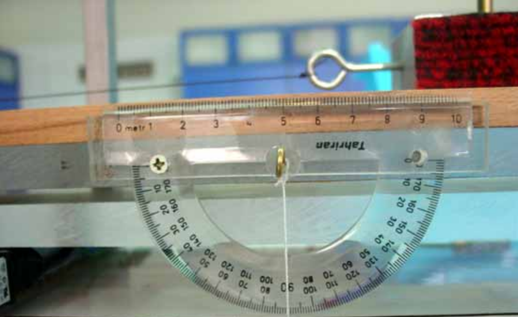
نقاله و شاقول برای خواندن زاویه شیب
