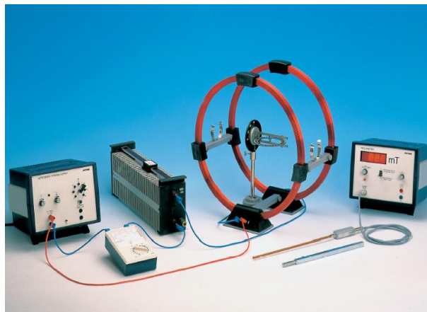
شکل ۴: چینش وسایل مورد نیاز آزمایش پیچه هلمهولتز
