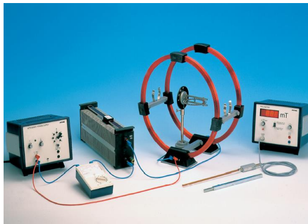
شکل ۴: چینش وسایل مورد نیاز آزمایش پیچه هلمهولتز
