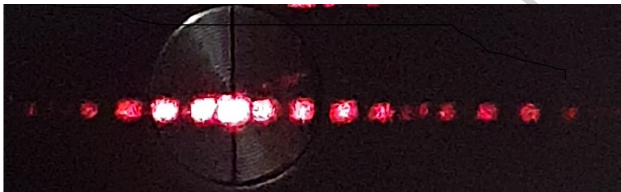
شکل ۱۰-۱: تصویر پراش دو شکاف بر روی فوتوسل
