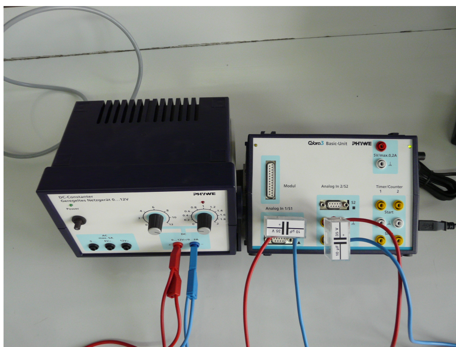
شکل ۶: نحوه اتصال خازن‌ها، لطفاً به جهت خازن‌ها دقت کنید. در صورت اشتباه قرار دادن، ممکن است به خازن‌ها آسیب برسانید.
