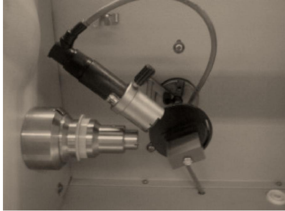
شکل ۷. هدف در زاویه ۲۰ درجه آشکارساز در زاویه ۱۲۵ درجه
