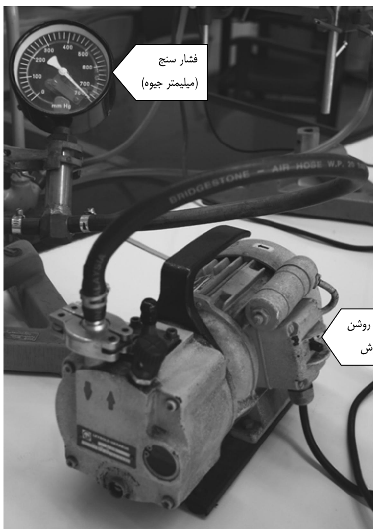
شکل ۶. پمپ جهت تخلیه محفظه
