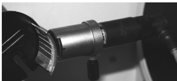
شکل ۹. ضخامت‌های مختلف آلومینیم در مسیر پرتو اشعه X و در مقابل آشکارساز گایگر
