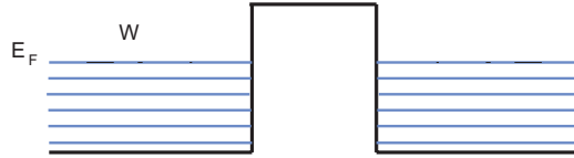
شکل ۲۲: سطوح انرژی الکترون های دو فلز در غیاب میدان الکتریکی - سطوح فرمی در دو فلز هم تراز هستند.
