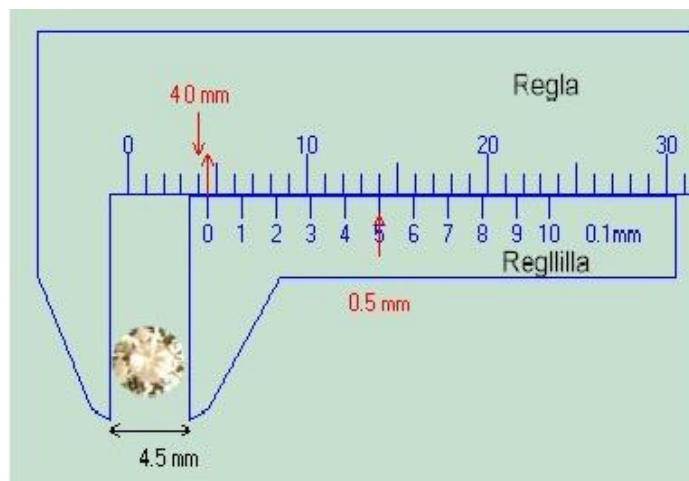
شکل ۲ - اساس کار کولیس
