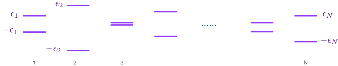
شکل ۸: مجموعه ای از اتم های دو ترازه که انرژی آنها یکسان نیست. اتم ها با هم برهم کنش ندارند.
